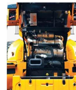
Per accedere agevolmente al vano motore a tenuta stagna e al vano di raffreddamento, il **cofano motore ribaltabile all'indietro può essere aperto completamente ed elettricamente**. Il vano motore è progettato per prevenire il rischio di incendi causati dall'afflusso di materiale estraneo.
