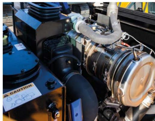
◀ Il **durevole sistema di post-trattamento** è protetto da un robusto sistema di supporto e di assorbimento degli urti. Il sistema previene i guasti causati da urti e vibrazioni durante l'esercizio.
