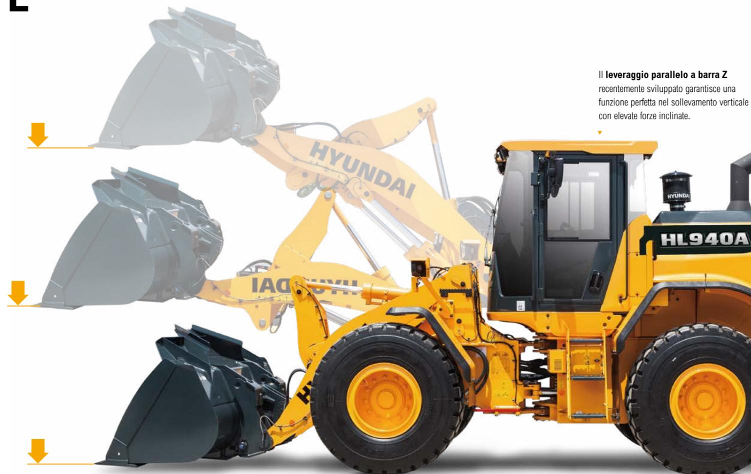
Il **leveraggio parallelo a barra Z** recentemente sviluppato garantisce una funzione perfetta nel sollevamento verticale con elevate forze inclinate.
