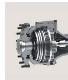
I **dischi freno** sono prodotti in materiale sinterizzato durevole che contrasta lo sviluppo di calore e l'insorgenza di vibrazioni. Prolungano la vita utile dei freni e hanno un disegno che facilita le operazioni di manutenzione.
