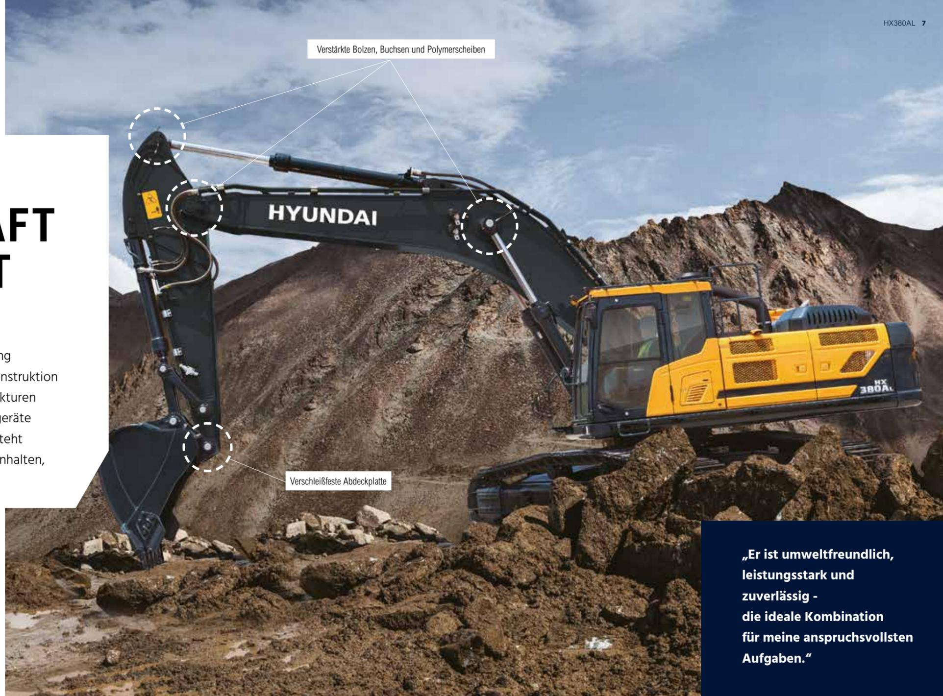
Verstärkte Bolzen, Buchsen und Polymerscheiben
